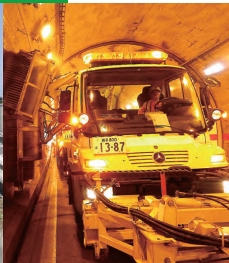
トンネル側壁清掃
